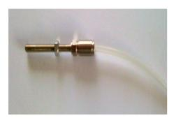
2. Einleitung mittels Additivweiche in den Gummischlauch (NW 5-6) nach der Gasdüse:
